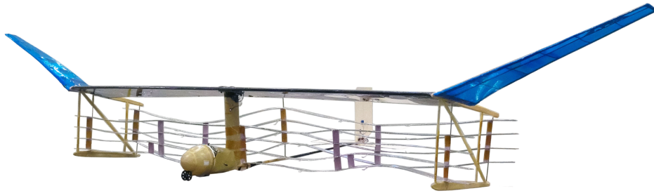
Figure 1.8: Picture of the MIT EHD aeroplane [32]
